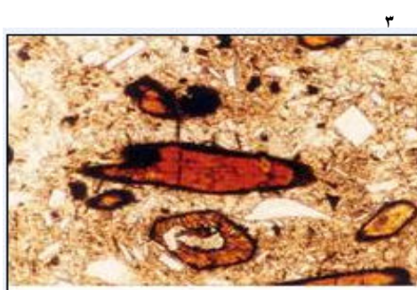
شکل ۳. بلورهای هورنبلند با حاشیه سوخته در آندزیت‌های منطقه آشتیان ( 5X10 XPL)
