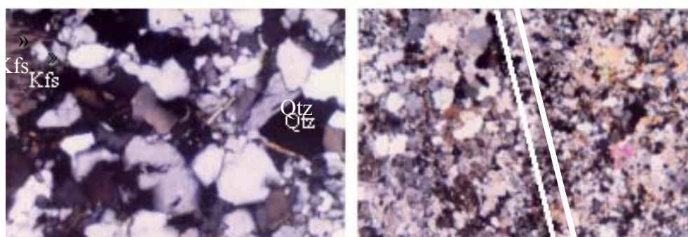
شکل ۱۹. پدیده سیلیسی شدن در هورنفلس‌های دربند شور در شمال گلپایگان (100.XPL). \times
