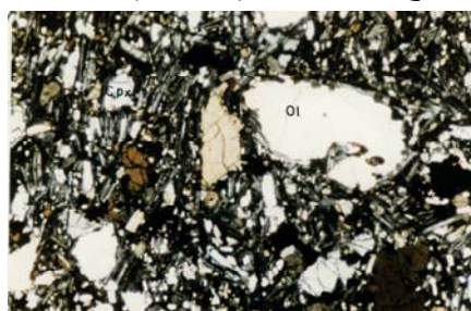
شکل ۱۰ - آلکالی الیوین بازالت با فنوکریستال‌های الیوین و اپاک در زمینه میکروکریستال‌های کلینوپیروکسن پلاژیوکلاز و کانی‌های اپاک (xpl، بزرگنمایی ۲۵x)
