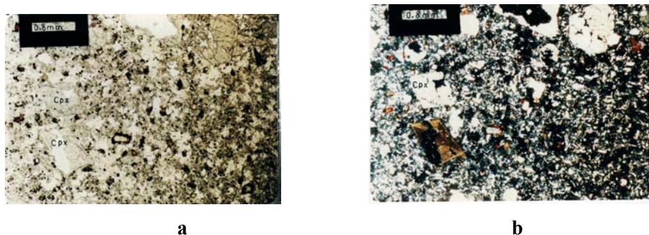
شکل ۱۲- بازالت غنی از کلینوپیروکسن (Cpx)، (بزرگ‌نمایی ۱۲x) (a) ppl (b) xpl
