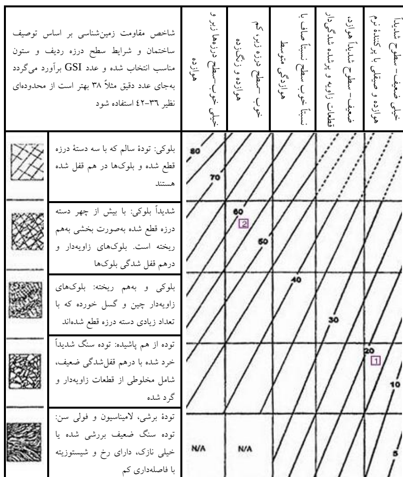
شکل ۸. طبقه‌بندی GSI توده‌های سنگی منطقه
