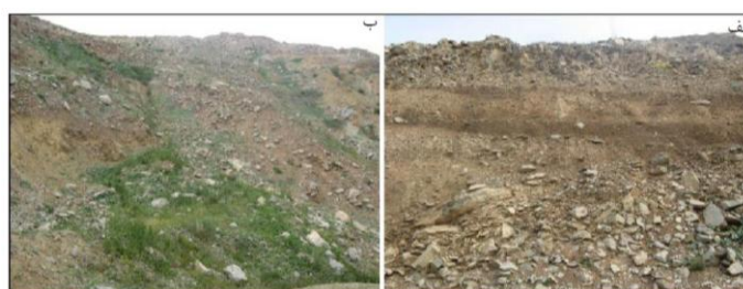
شکل ۷. تصویر قرارگیری قطعات آندزیت بازالیت به‌طور ناهمگن در مجاورت مصالح ماسه، سیلت و رس
