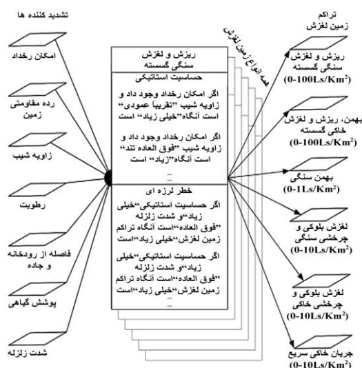
شکل ۱۱. نمودار جریانی داده‌ها برای بخش مقدار تراکم خطر کامل، معرف ورودی‌ها (اطلاعات تشدید کننده)، خروجی‌ها، و ترتیب قوائد [۱۱]، [۱۲]
