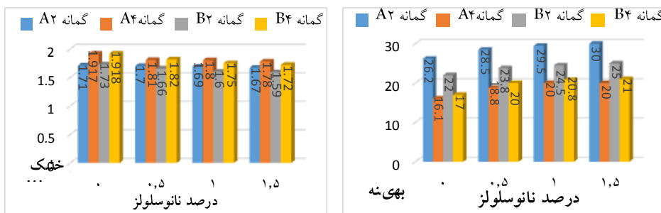
شکل ۱۰. تغییرات وزن مخصوص خشک بیشینه و درصد رطوبت بهینه برای درصد‌های مختلف ترکیبی با نانو سلولز، از هر دو عمق و هر دو گمانه انتخابی
