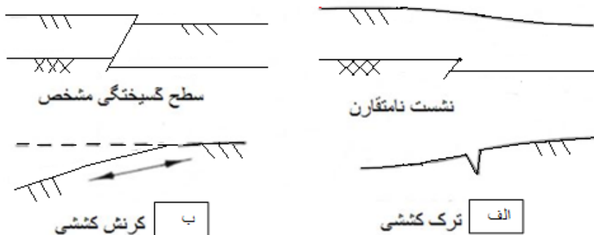
شکل ۱. حالت‌های گسیختگی مرتبط با گسلش سطحی
