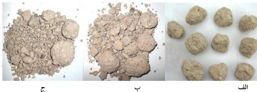
شکل ۱۱. تغییرات نمونه‌ها در آزمایش وارفتگی، الف) قبل از انجام آزمایش، ب) بعد از مرحله اول، ج) مرحله دوم
